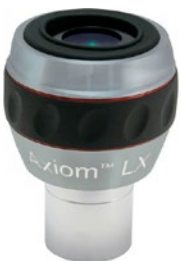
MX: 500102 USA: 93396 Ocular Axiom LX Distancia focal: 15 mm Campo de visión: 82° Salida ocular: 1.25"
